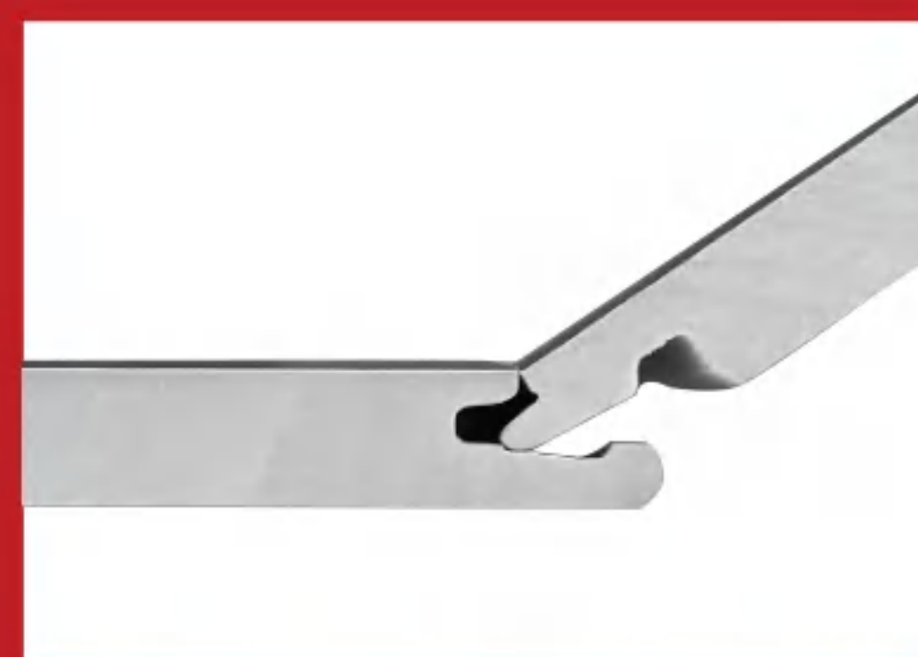
3.将地板凸榫反向以45° 倾斜嵌入凹槽
