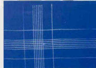
تم اختبار رينوبلاست KP1+ Rhenoplast وفقاً للمعيار DIN EN 478. تم طلاء السطح وبعد جفافه تم اختبار الالتصاق من خلال اختبار القطع المتقاطع. يجب ألا يفصل أي سطح. النتيجة: 0 = GT، أفضل التصاق.
